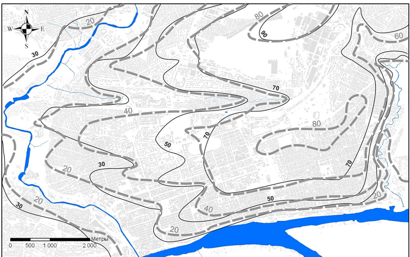
Рисунок 9 – Карта гидроизогипс центральной части г. Ростова-на-Дону Сплошными линиями показаны горизонталы, штриховыми - гидроизогипсы
